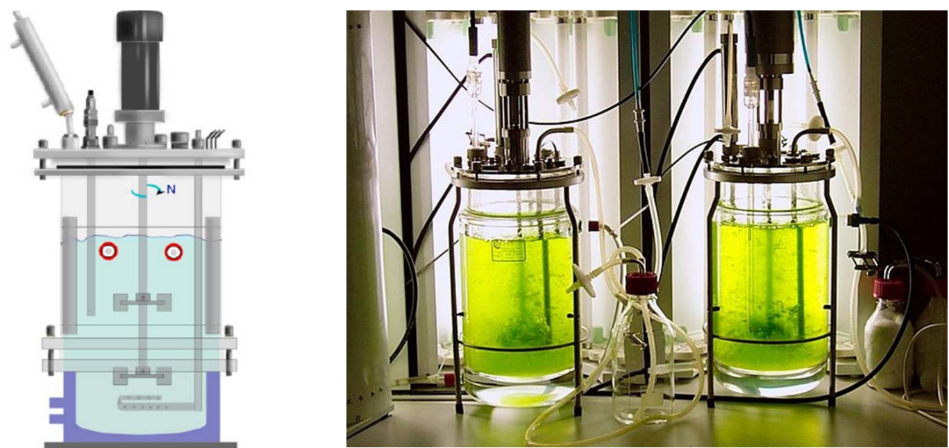
Figura 1. Biorreator convencional tipo tanque agitado e aerado.
